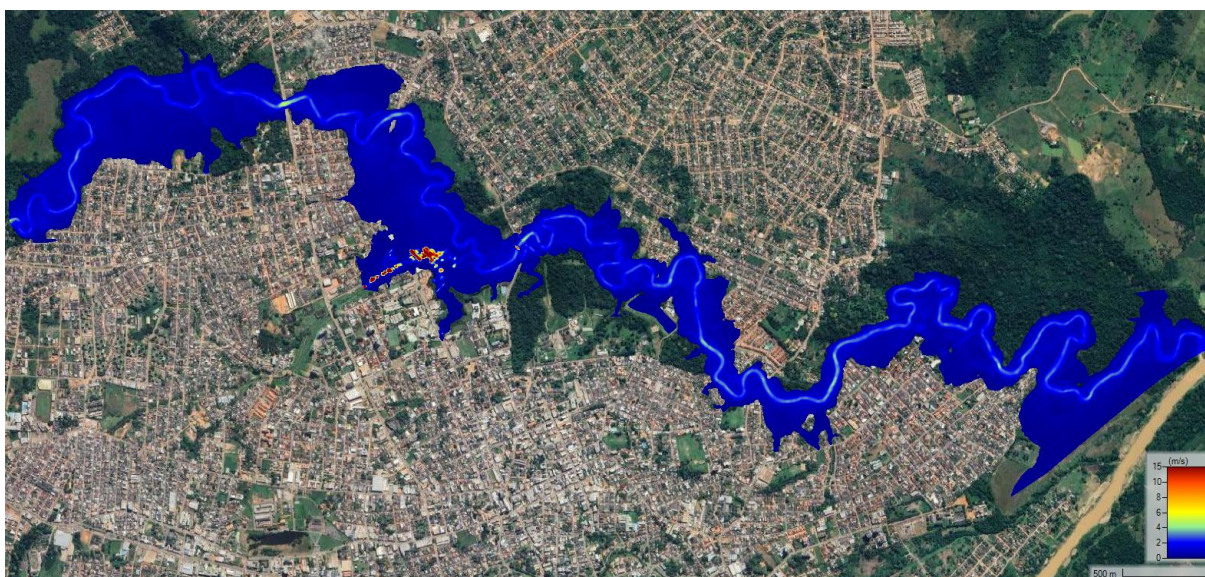
Figura 34 — Mapa ilustrativo das velocidades máximas de escoamento em cada do ISF gerada no HEC-RAS para o tempo de retorno de 50 anos.
